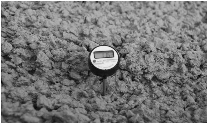
Bild 5: Messung der Frischbetontemperatur ( T_L ) bei der Übergabe des Betons
