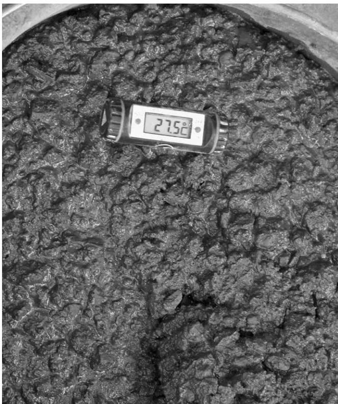
Bild 7: Vermehrte Kontrolle der Frischbetontemperatur auch nach Probekörperherstellung
